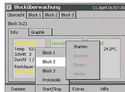
Programmstart beim Labcyler triple. Block 1 befindet sich bereits in einem Lauf, Block 2 wird gestartet.
