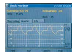
Graphische Anzeige des Temperaturverlaufs während einer 3-Schritt-PCR.
